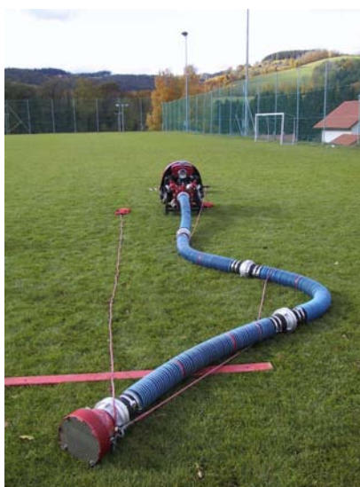
Bild 11 Richtig ausgelegte Saugschlauchleitung
